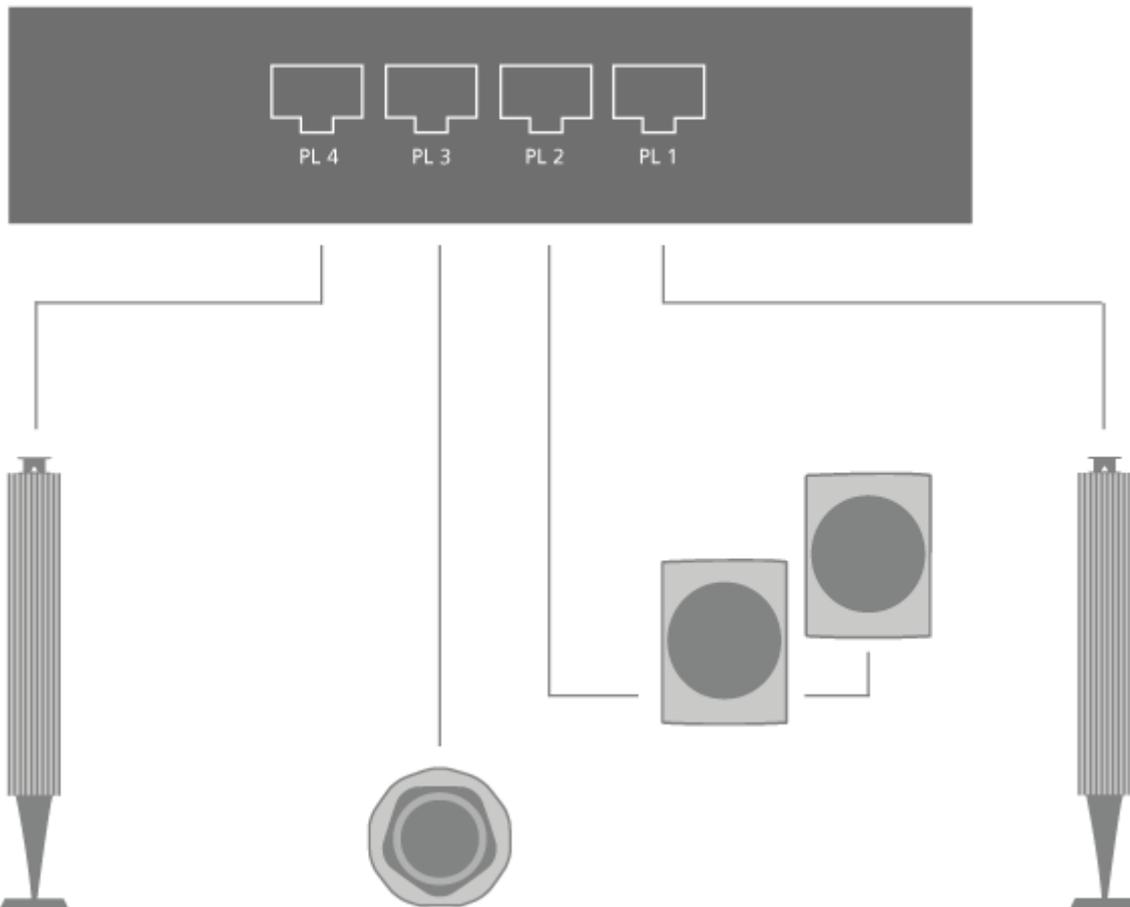
На иллюстрации показан пример системы колонок, состоящей из двух фронтальных колонок, двух последовательно подключенных тыловых колонок и сабвуфера.
